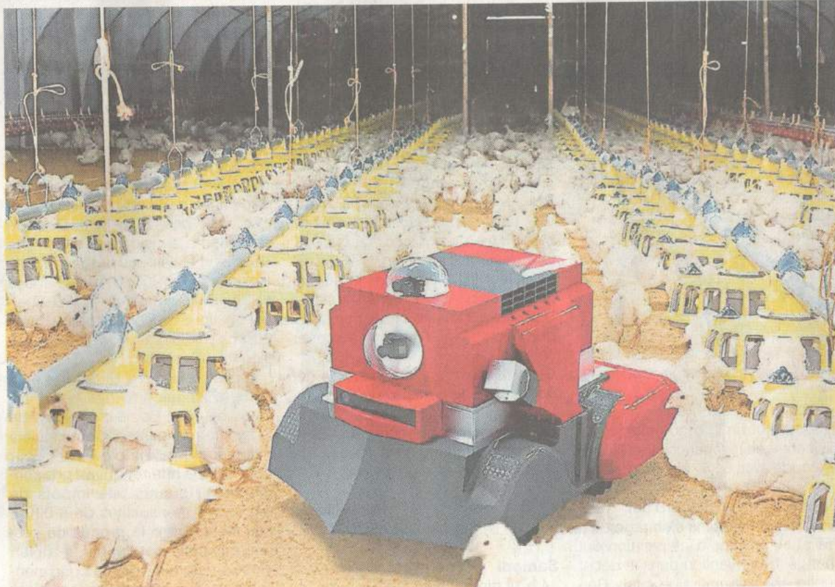
Le robot Octopus Poultry Safe permet de nettoyer et désinfecter les poulaillers.
